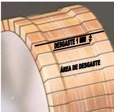
FIG.1 Conmutador de la armadura
